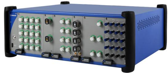
当光功率高速变化时，准确快速捕捉到光功率值，对于光功率计是一个极大地挑战。传统光功率计无法满足高速准确的测量需求时，为此高速光功率计应运而生。传统光功率计为了测量数值的准确性和大动态范围的需求，在功率值积分上和量程切换上都占用了大量的时间，所以不能快速而准确地输出有效的光功率值，因此它无法满足高速自动化测试系统及高速监控系统等场景的应用需求。
