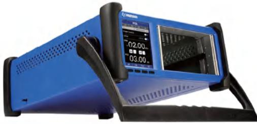
ALPHA 是一款紧凑型可编程的双槽位平台，采用 ARM+linux 架构，内置 3.2" 触摸显示屏，自带 GUI，支持按键和触摸控制，可以快速简单进行准确的测量，不需要另加 PC 等控制设备，灵活方便。ALPHA 机箱内置重力感应器，支持横屏和竖屏放置。非常适用于实验室或者小型自动化生产测试环境。
