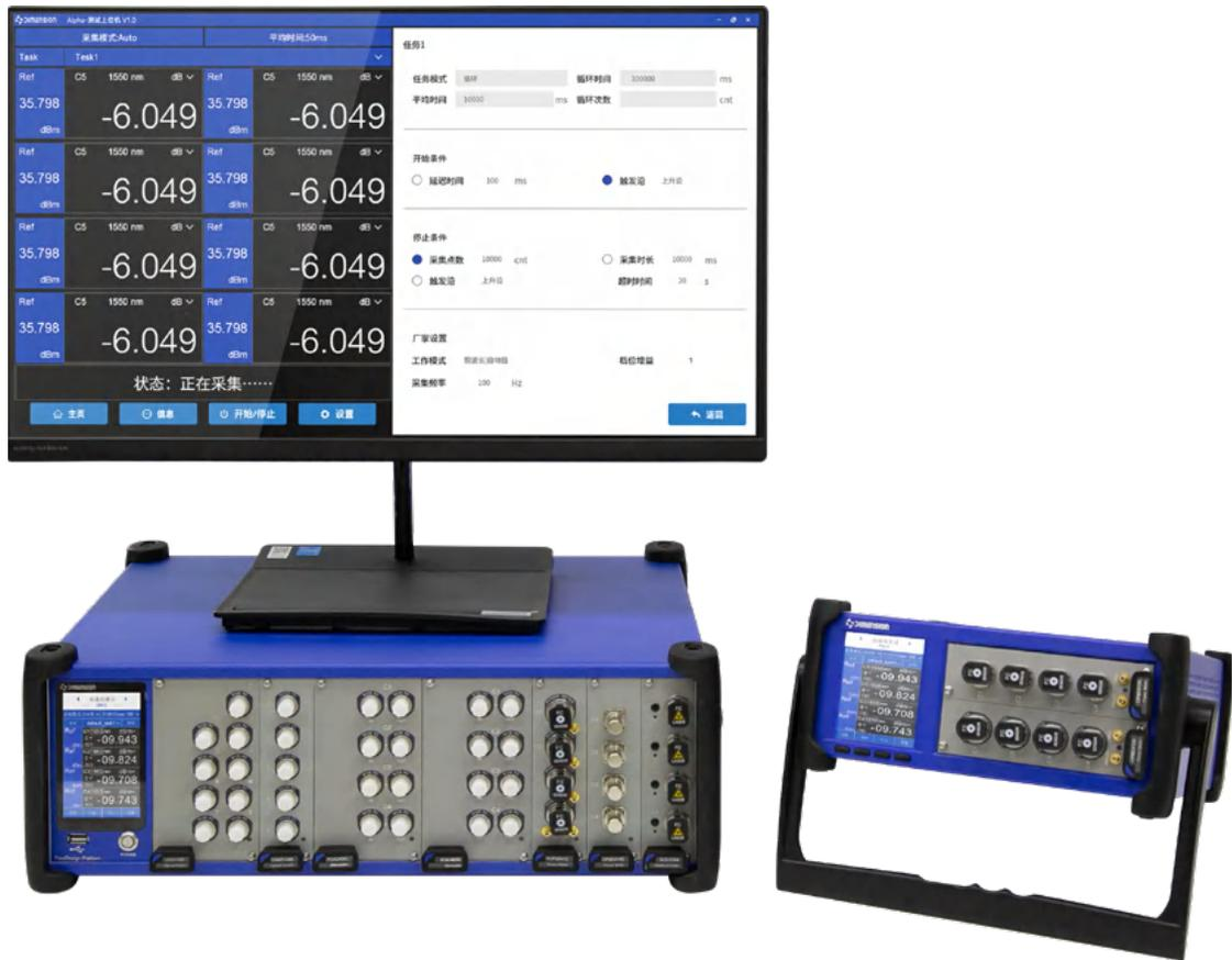
维度科技推出的 FreeDesign 智能仪器开发平台提供 1 机箱 +N 模块的组合方式，助力用户简单高效的自主开发、搭建多种类测试测量仪表与系统。FreeDesign 可集成多种测量模块于一体，在如 PC 主机大小一般的机箱内即可完成大量通用测试模块的自定义组合集成。是科研系统与自动化产品测试中缩短长期投入与提升效率的开发利器。
