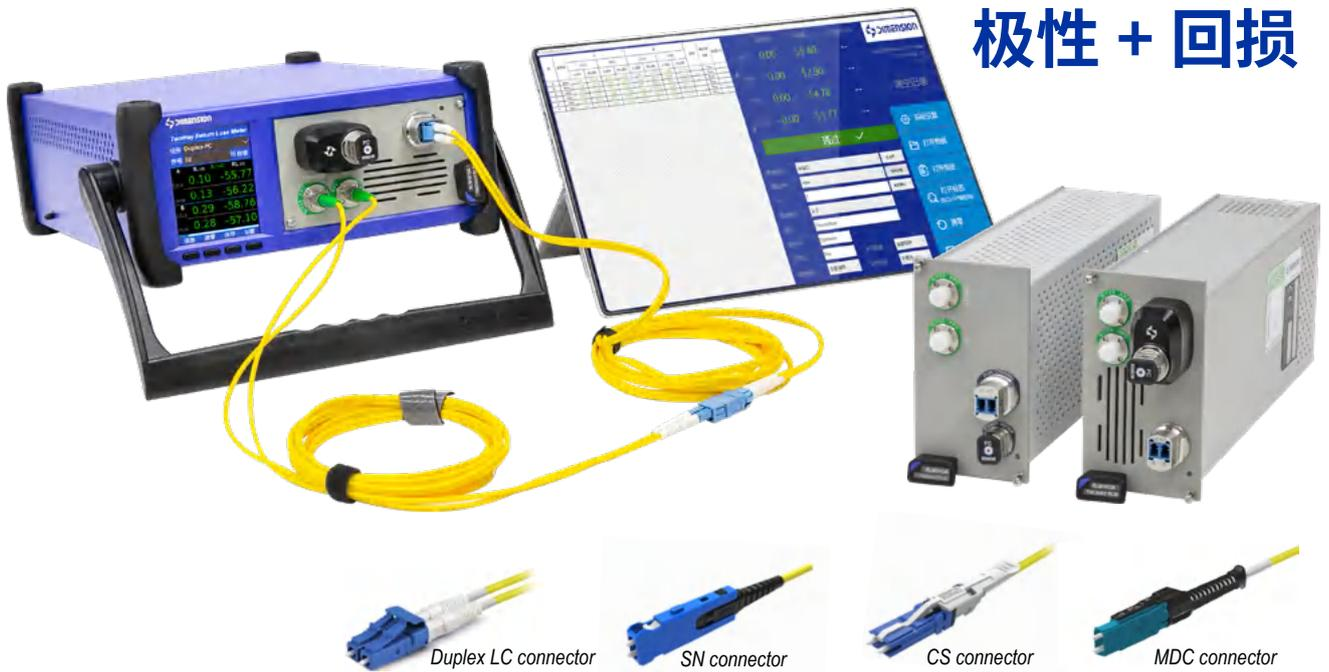
TwoWay 双通道极性回损测试仪是维度科技针对当前双联光纤跳线测试遇到的问题，使用创新的设计理念，可实现 IL、RL 和 Polarity 同时自动测试的新型产品。IL、RL 和 Polarity 同时测试时间小于 1.2s（快速模式），可以大大提高测试效率，降低客户设备投入成本，同时在提升效率的前提下还保证了 IL、RL 的测量可靠性，最低能够实现 -80dB 的回波损耗探测（单模）。TwoWay 快速而准确的测量功能，是提高生产效率和品质管控的有效工具。
