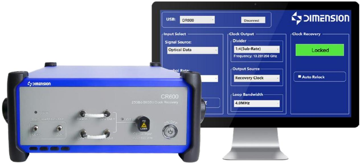
维度 CR600 光电时钟恢复单元支持 NRZ 和 PAM4，可在 60Gbd 范围内提供光电时钟信号的恢复。系统集成了单多模一体的光电转换和时钟恢复电路，可同时应用于电学和光学应用。满足高灵敏度和低固有抖动的要求，测量精度优良。提供简洁的用户界面，便于设定和使用。维度 CR600 光电时钟恢复单元为计算机系统测试、光通讯系统测试、标准符合性验证提供了性能优良、高可靠性和成本可控的光电时钟恢复的选择。
