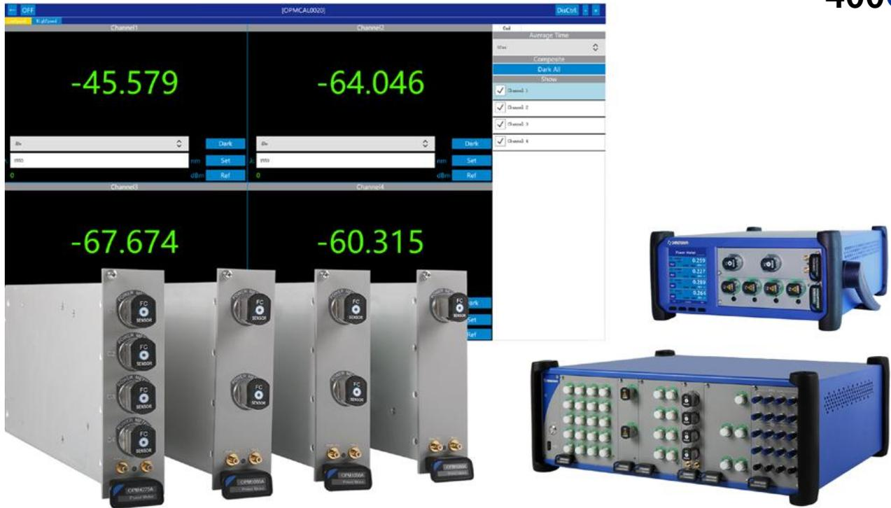
当光功率高速变化时，准确快速捕捉到光功率值，对于光功率计是一个极大地挑战。传统光功率计无法满足高速准确的测量需求时，为此高速光功率计应运而生。传统光功率计为了测量数值的准确性和大动态范围的需求，在功率值积分上和量程切换上都占用了大量的时间，所以不能快速而准确地输出有效的光功率值，因此它无法满足高速自动化测试系统及高速监控系统等场景的应用需求。
