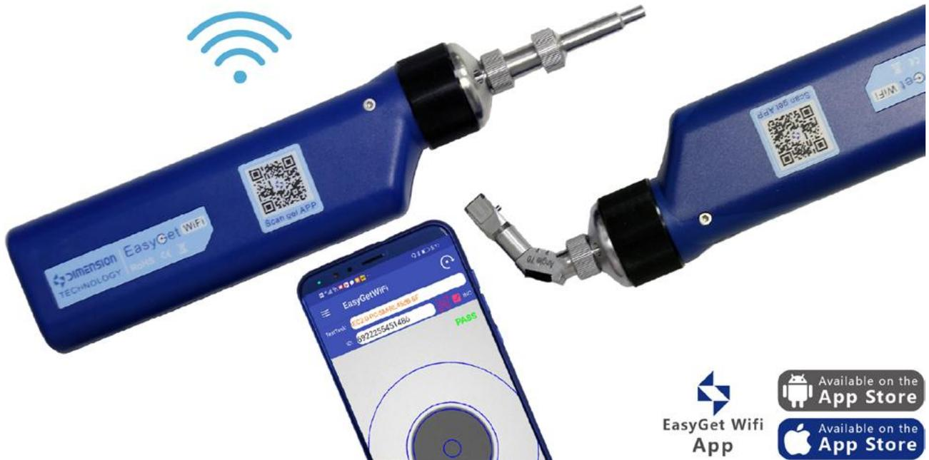
光纤连接器端面的脏污或损坏将直接导致光信号的衰减甚至光路阻断，因此，轻巧便携、快速直观的无线光纤端面检测仪成为现场技术人员必不可少的检测工具。
