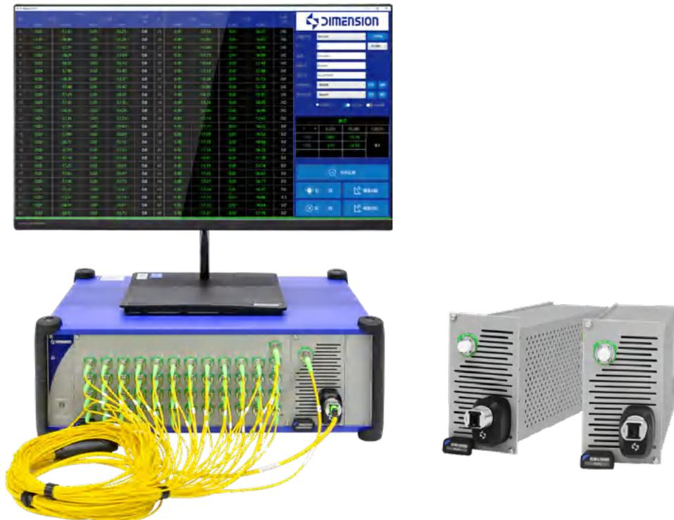
Dimension 多芯插回损测试仪采用高稳定度光源和高精度光功率计, 实现免缠绕的回损测试和高速的插入损耗测试。单次单波长损耗检测时间小于 0.6s, 最低能够实现 -80dB 的回波损耗探测。RLM 包含单模与多模共 6 个测试波长 (多模 :850nm、1300nm, 单模 :1310nm、1490nm、1550nm、1625nm), 优化设计的积分球既可以测量密集多通道 MTP/MPO 连接器的损耗, 也可以测量双联 LC 等器件上的损耗。RLM 快速而准确的测量功能, 是提高生产效率和品质管控的有效工具。
